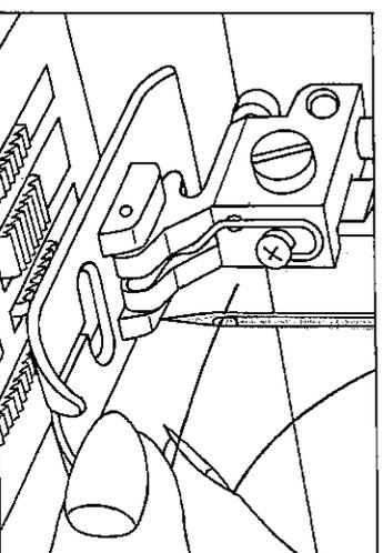
Den Oberfaden von vorn nach hinten durch das Nadelöhr fädeln.
