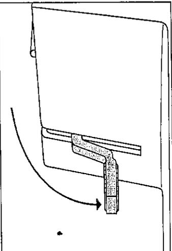
Fadenabschneider P: Fäden einlegen und nach unten ziehen.
