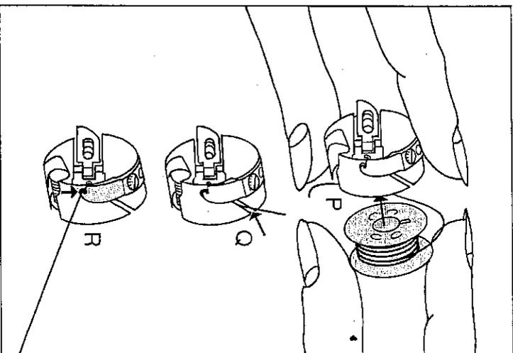
**Spule einlegen P** (Faden nach hinten).
