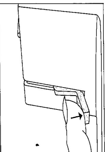
**Beim Einlegen extrem dicker Stofflagen Hebel 13 höher anheben.**
