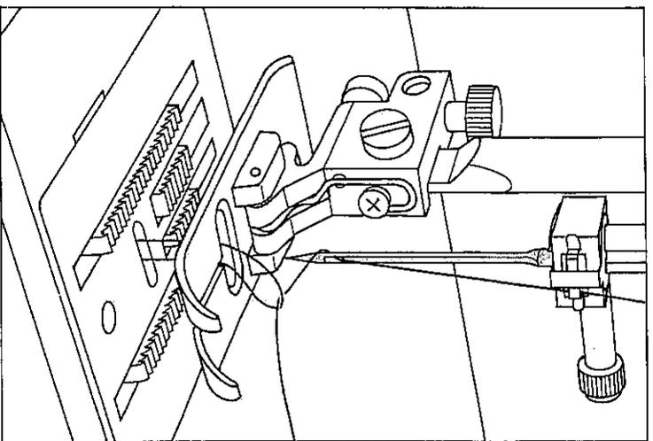
**Untarfaden heraufholen:** Oberfaden festhalten. Handrad nach vorn drehen und einen Stich nähen bis Nadel und Fadenhebel wieder oben stehen. Mit dem Oberfaden den Untarfaden nach oben ziehen.
