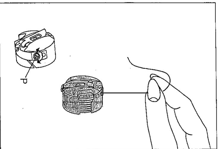
**Unterfadenspannung prüfen:** Kapsel leicht ruckartig aufwärtsbewegen. Sie muß stufenweise niedersinken. (Einstellschraube P nach links drehen = loser, nach rechts drehen = fester).
