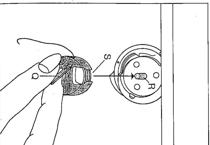
**Spulenkapsel einsetzen:** ● *Hauptschalter 24 ausschalten.* Klappe Q anheben und die Kapsel bis zum Anschlag auf Stift R schieben. Ausschnitt S muß dabei nach oben zeigen.
