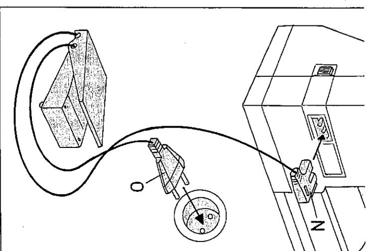
**Elektrischer Anschluss:** Anlasser auf den Boden stellen. Stecker N in die Maschine, und Stecker O in die Wandsteckdose stecken.
