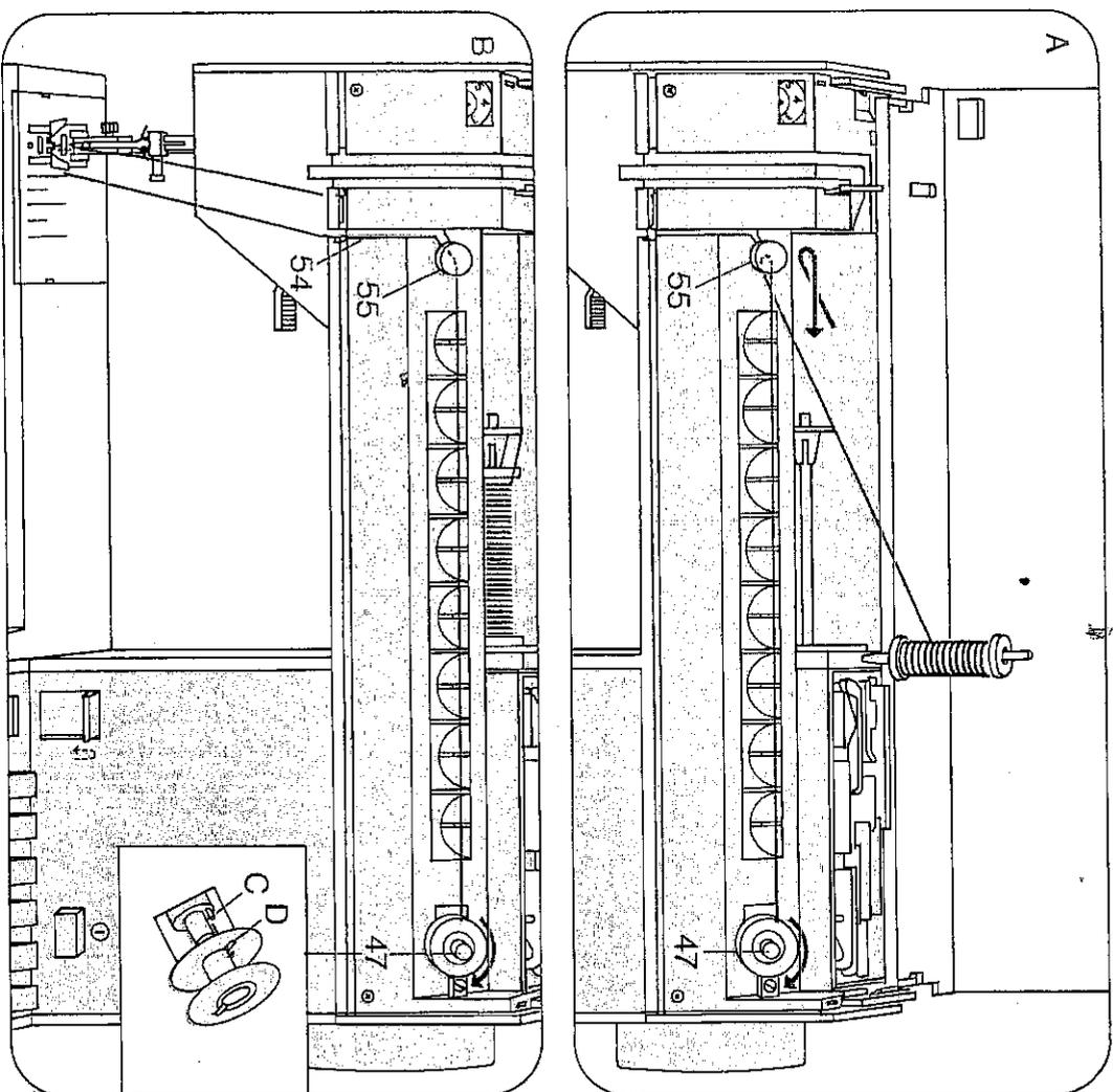
**Spulenkapsel und Spule herausnehmen**
