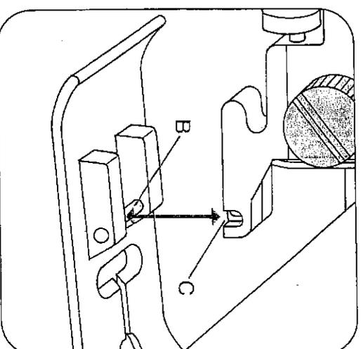
Stoffrückeheber 42 herunterlassen und den Nähfuß dabei so schieben, daß der Steg B in die Nute C einrastet.
