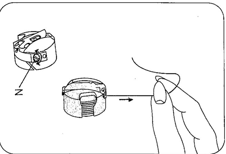
**Untertfadenspannung prüfen:** Kapsel leicht ruckartig aufwärtsbewegen. Sie muß stufenweise niedersinken. (Einstellschraube N nach links drehen = loser, nach rechts drehen = fester).
