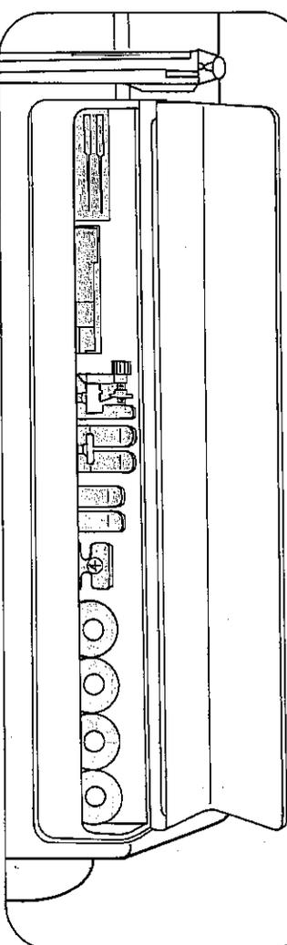
Den Klappdeckel 127 für das Zubehörfach 128 öffnen. Darunter ist Platz für Nähfüße, Spulen und Nadeln. Das Zubehör muß wie in der Abbildung gezeigt, eingeordnet werden.
