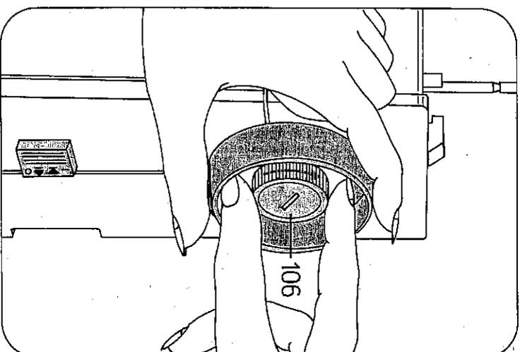
**Nähwerk einschalten:** Handrad festhalten und Scheibe 106 nach hinten drehen. Dann Handrad nach vorne drehen, bis es einrastet.
