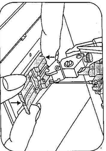
**Nähfuß auswechseln:** ● **Hauptschalter 125 ausschalten.** Die Nadel hochstellen. Den Nähfuß hinten nach unten drücken und vorne etwas anheben. Den Knopflochfuß vorne nach unten drücken.
