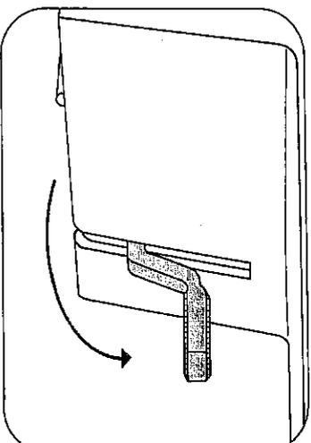
**Fadenabschneider N.** Fäden einlegen und nach unten ziehen.
