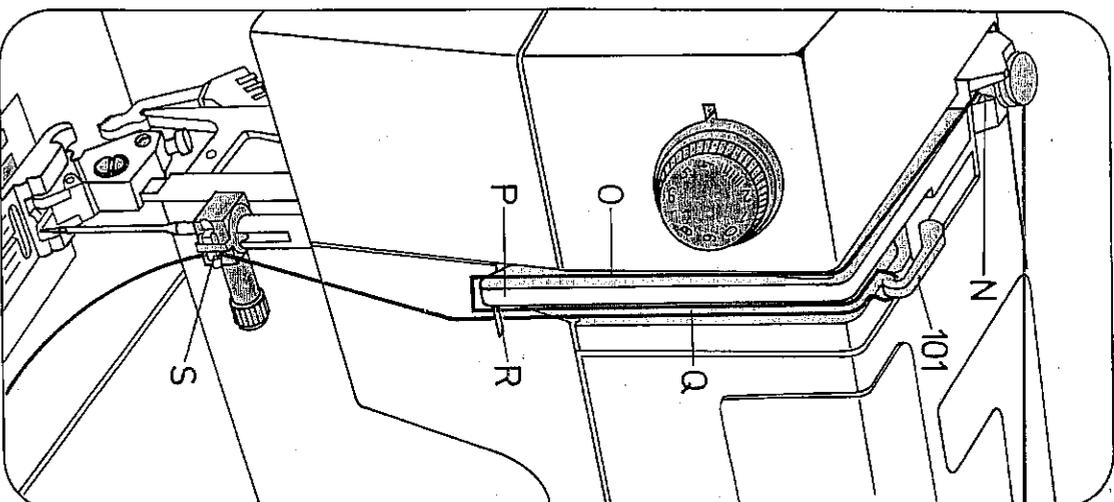
**Oberfaden einlegen:** ● **Hauptschalter 125 ausschalten.** Nadel und Fadenhebel 101 müssen oben stehen. Nähfuß anheben. Den Faden von der Garnrolle in die Spulervorspannung, durch die Öffnung N, den Schlitz O, hinter das Führungsstück P, nach oben in den Schlitz Q, durch den Fadenhebel 101, zurück durch den Schlitz Q, hinter die Führung R und in die rechte Fadenführung S am Nadelhalter ziehen.
