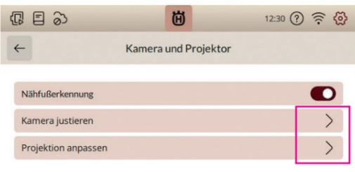
Für eine genaue Projektionsvorschau im Nähmodus und für einen exakten Stickrahmenscan, lassen sich Projektor und Kamera kalibrieren. Eine Anleitung, für die Kalibrierung erhalten Sie über die Pfeiltasten die nach rechts zeigen.
